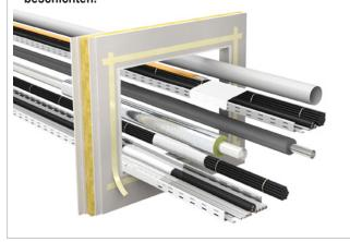
2. Nichtbrennbare Rohre mit FEF-Isolierung, EIR und speedpipes" mit DG-CR 1.5 umwickeln. Brennbare Rohre ggf. mit DG-CR BS umwickeln.
