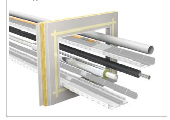
3. Mineralfaserplatte zuschneiden (Ausschnitte für Kabel, Rohre, etc. herstellen).
