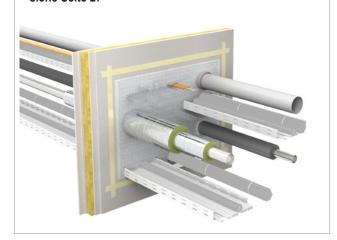
8. Schlussanstrich mit FLAMMOTECT-A. Brennbare Rohre mit Rohrmanschette gemäß abZ mit Gewindestangen M6 befestigen. Details siehe Seite 23
