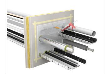
6. Kabel mit FLAMMOTECT-A beschichten. Länge ≥ 200 mm (Trockenschichtdicke ≥ 1,0 mm). Details, S. 17
