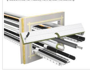
4. Kanten der Mineralfaserplatte mit FLAMMOTECT-A-Farbe einstreichen (Trockenschichtdicke ≥ 1 mm) und Platte stramm sitzend einbringen.
